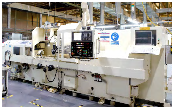
▲ 业内高端设备, 可对应集各类大中小型平面拉刀、花键拉刀、圆拉刀、键槽拉刀等一体化修磨。
